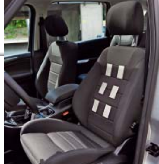
Nello schienale di questo sedile sono integrati componenti che consentono una misurazione capacitiva dell'ECG -A Foto: Ford
